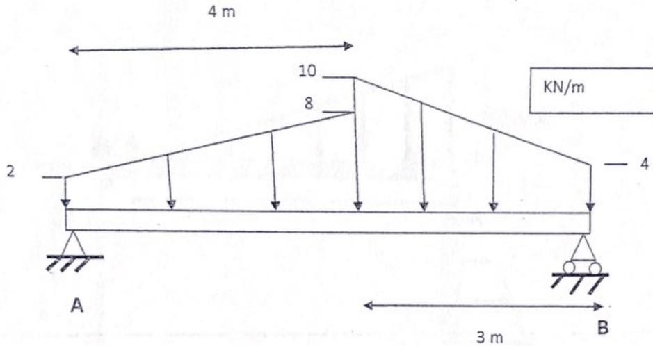
Calculer les réactions en A et B
