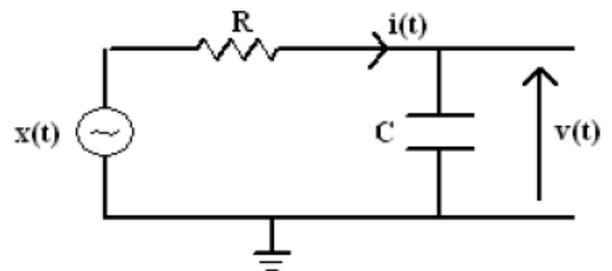
On rappelle que la charge  $q(t)$  du condensateur vaut  $C \cdot v(t)$  et que l'intensité dans le circuit est donnée par  $i(t) = \frac{dq(t)}{dt}$ . Les tensions vérifient l'égalité  $x(t) = v(t) + R \cdot i(t)$
