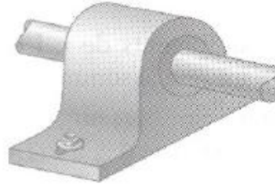
Charnière et palier à charge radiale
