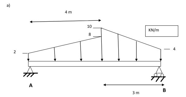
Calculer les réactions en A et B
