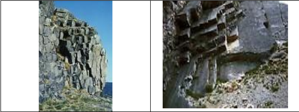
Fig. 18 Photos de surfaces de discontinuités sans mouvement relatif apparent a : « orgues » basaltiques ; b : diaclases en massif calcaire
