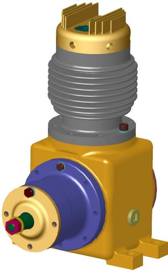
FIGURE 3 – vue extérieure du micro-compresseur.
