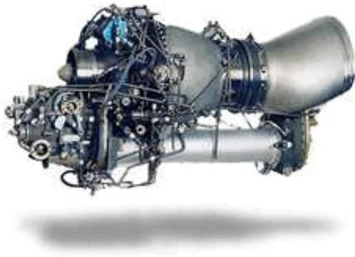
FIGURE 30 – Moteur Arriel 1 de 750 CV.
