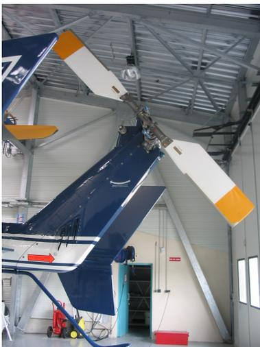
FIGURE 27 – Rotor arrière de l'hélicoptère, tournant à  $2000 \text{ tr/min}$ .
