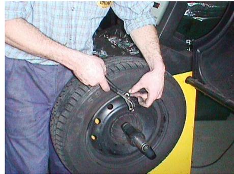
FIGURE 26 – Mise en place au marteau d'une masselotte sur la jante.
