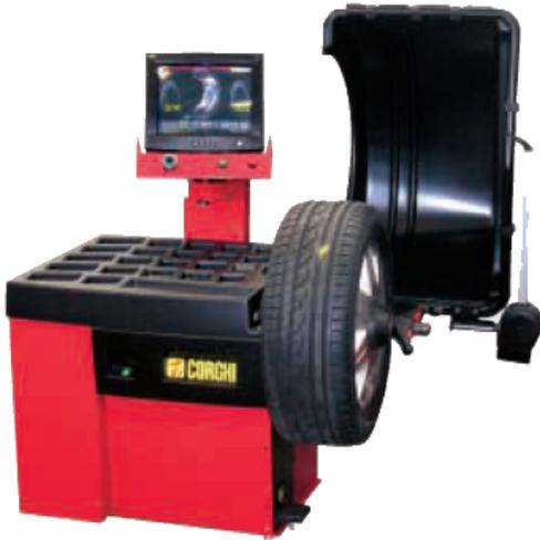
FIGURE 25 – Équilibreuse de roue de voitures.
