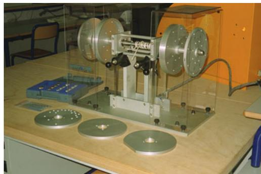
FIGURE 32 – Banc d'équilibrage du laboratoire de SI.
