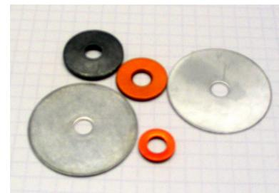
FIGURE 29 – Masselottes de masses calibrées pour l'équilibrage.
