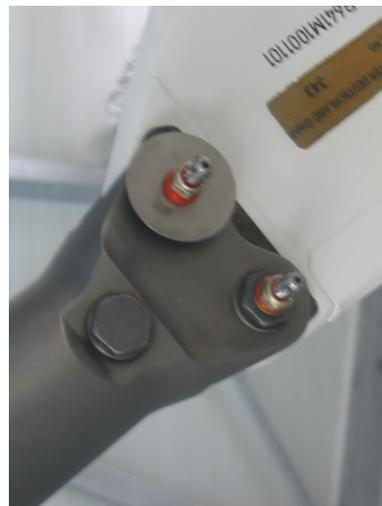
FIGURE 28 – Montage des masselottes sur le rotor en quatre points.
