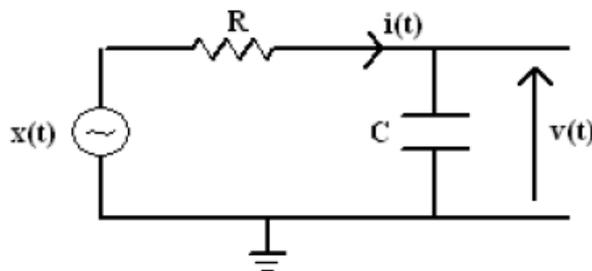
On considère le système constitué d'un générateur basse fréquence fournissant une tension d'entrée  $x(t)$ , d'une résistance  $R$  et d'un condensateur de capacité  $C$ . Le signal de sortie que l'on étudie est la tension  $v(t)$  aux bornes du condensateur.
