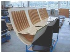
Bord d'attaque de voilure sur Airbus A340-500/600.
