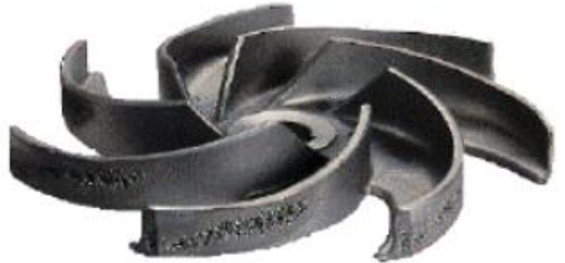
Corrosion-cavitation d'une aube de pompe
