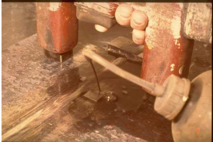
Figure 13 Examen à l'aide d'une encre magnétique noire, témoin AFNOR N°1
