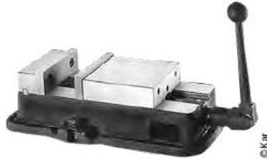
L'étau simple est le plus répandu. Fixé à la table de la fraiseuse ou à un autre dispositif de montage, il convient à une vaste gamme d'opérations de fraisage. Son montage est rapide et sécuritaire si l'on prend soin de ne pas trop le serrer afin d'éviter l'éjection de la pièce.
