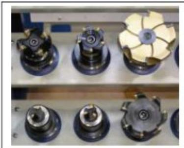
Il existe énormément de fraises différentes de par le nombre de dents, le diamètre, la forme du corps de fraise et de sa plaquette, l'attachement de la fraise et de sa plaquette, les angles de coupe d'attaque, etc. Nous détaillerons plus tard ces variantes.
