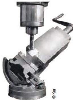
L'étau universel permet le fraisage et le perçage à des angles composés. Sa base, composée d'axes pivotants, lui accorde une liberté de mouvement pour la réalisation de pièces complexes.
