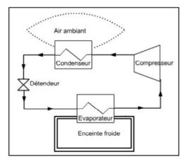
Le principe consiste à évaporer un fluide frigorigène à basse pression (et donc basse température), dans un échangeur en contact avec l'enceinte froide. Pour cela, il faut que la température d'évaporation du fluide frigorigène soit inférieure à celle de l'enceinte froide.
