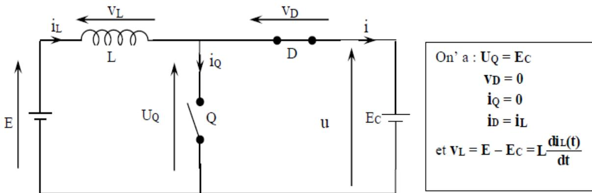
Déterminons le courant  $i_L(t)$  : on a  $E = E_c + L \frac{di_L(t)}{dt}$  avec  $i_L(\alpha T) = I_{LMAX}$  et  $i_L(\beta T) = 0$
