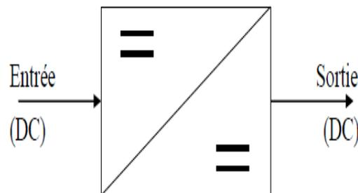
Ils sont principalement utilisés pour la variation de vitesse des moteurs à courant continu ainsi que dans les alimentations à découpage à courant continu.
