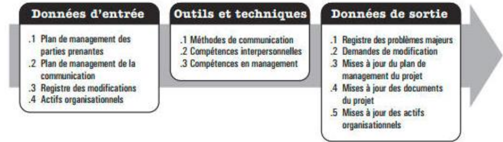
Figure 13-8. Gérer l'engagement des parties prenantes : données d'entrée, outils et techniques, et données de sortie
