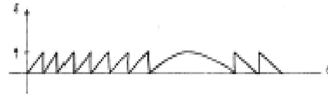
Si l'on suppose que le signal est de répartition continue, avec un écart type supérieur à quelques quantum, on peut admettre que l'évolution du bruit de quantification est en dent de scie. On peut ainsi calculer sa puissance en terme de moyenne quadratique (elle correspond à la puissance du signal dans une résistance de  $1\Omega$ ) :
