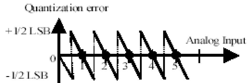
*L'évolution du bruit de quantification est une évolution en dent de scie avec une amplitude égale au quantum. En fonction du principe de quantification utilisé, les caractéristiques du bruit de quantification varient.*
