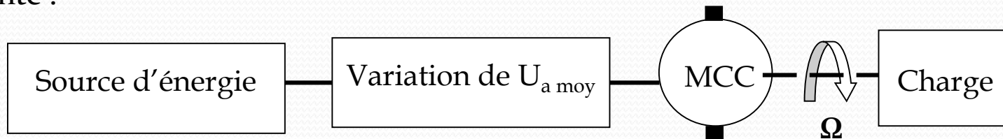
Schéma synoptique d'un variateur pour MCC
