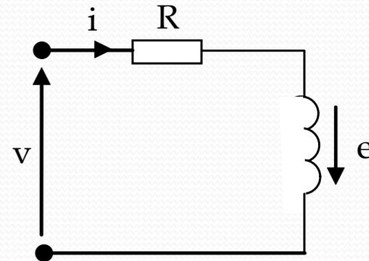
Modèle d'un enroulement avec f.é.m.
