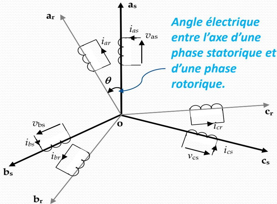
Représentation des six enroulements de la machine asynchrone (s : stator, r : rotor).
