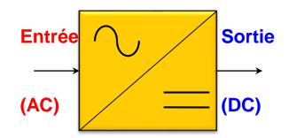
Les redresseurs à diodes (redresseurs non commandés) ne permettent pas de faire varier le rapport entre la ou les tensions alternatives d'entrée et la tension continue de sortie. De plus, ils sont irréversibles: la puissance ne peut aller que du côté alternatif vers le côté continu.
