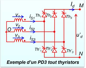
une tension redressée  $v_{MO}$  formée de q portions de sinusoïdes, qui a pour valeur moyenne:  $\bar{v}_{MO} = \frac{q}{\pi} V_m \sin\left(\frac{\pi}{q}\right) \cos \alpha$
