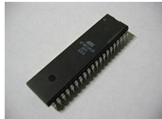
Un microcontrôleur boîtier DIP .
