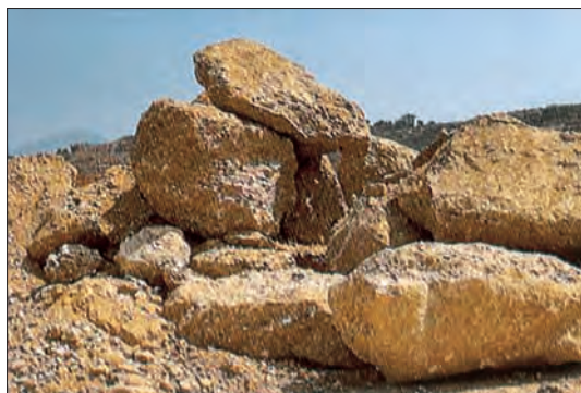
Roche siliceuse (poudingue) de la classe R 42 .
