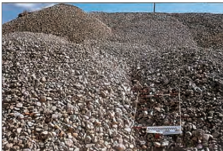
Stock de grave alluvionnaire propre de classe D 2 insensible à l'eau
