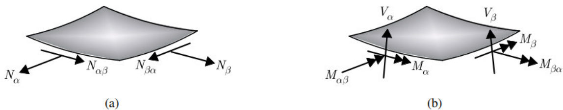
Fig. 2.7 Efforts intérieurs : (a) membranaires ; (b) flexionnels.
