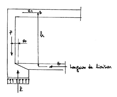
1) Admettre le moment  $M=P\times e$ , dans la mesure ou le plancher superieur est capable de reprendre une réaction horizontale H1.
