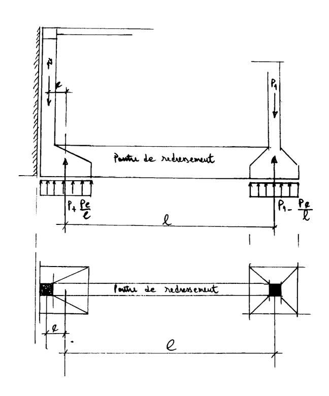
le moment P.e. dans la semelle est repris par la poutre de redressement et si nous appelons l, la distance entre les deux semelles, on devra dimensioner la semelle excentrée en fonction d'un effort :
