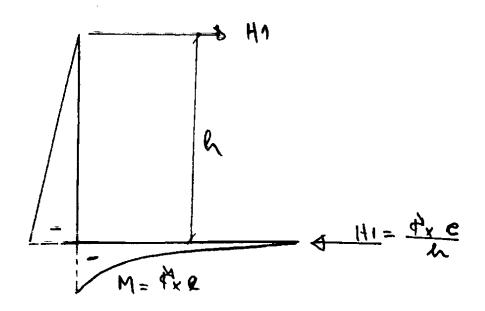
Au niveau de la semelle, cette réaction est équilibrée par les contraintes de frottements de la semelle sur le sol.
