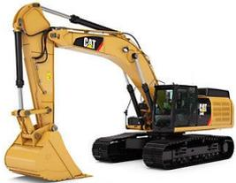
Une pelle hydraulique est un engin automoteur à roues ou à chenilles dont :
