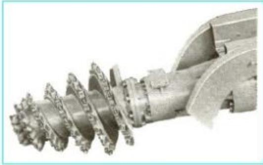
Figure 2 - Bras à attaque radiale (Eickhoff)
