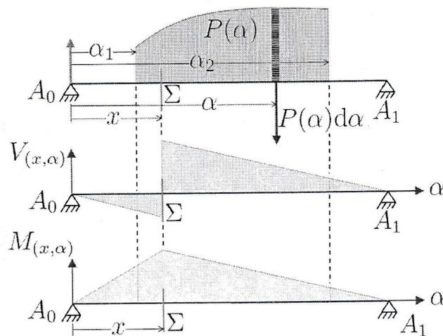
FIGURE 3.3 – Charge répartie sur la poutre
