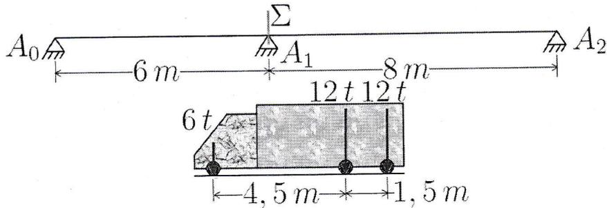
FIGURE 3.14 – Schéma de l'exercice 12 (pont à 2 travées)
