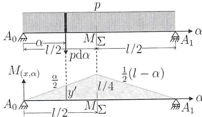
FIGURE 3.5 – Ligne d'influence du moment fléchissant à la section  $\Sigma$
