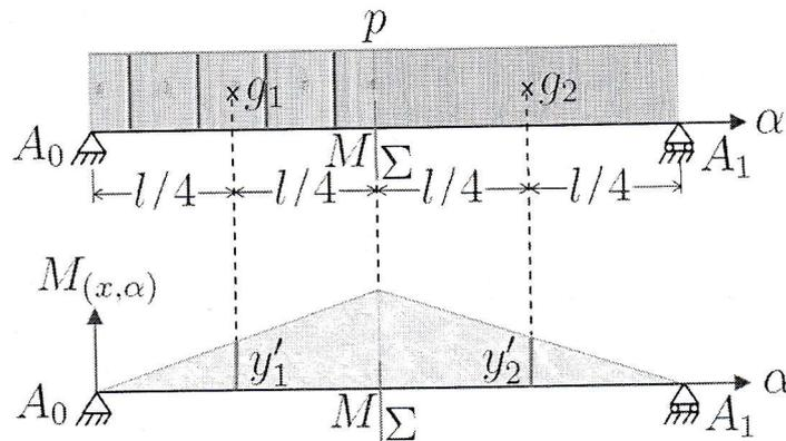
FIGURE 3.6 – Moment total à la section  $\Sigma$
