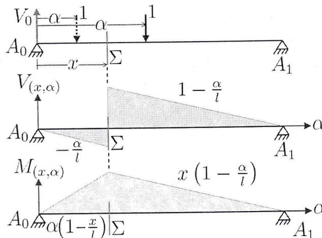
FIGURE 3.1 – Lignes d'influence de  $V$  et  $M$  d'une poutre isostatique
