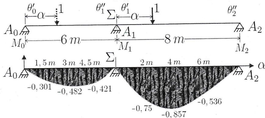
FIGURE 3.15 – Ligne d'influence du moment fléchissant à la section  $\Sigma$
