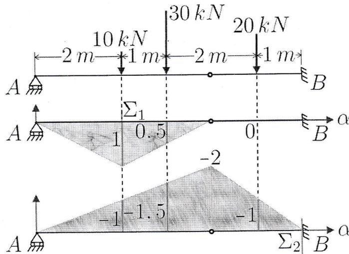
FIGURE 3.11 – Moment total d'un chargement ext. aux sections  $\Sigma_1$  et  $\Sigma_2$
