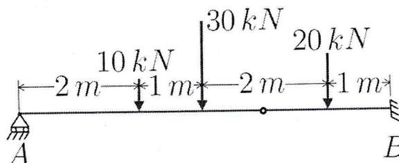
FIGURE 3.8 – Chargement extérieur appliqué à la poutre - Exercice 10
