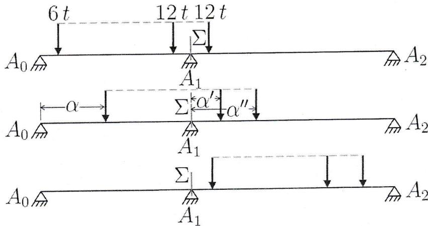
FIGURE 3.16 – Positions potentielles possibles du camion sur les deux travées
