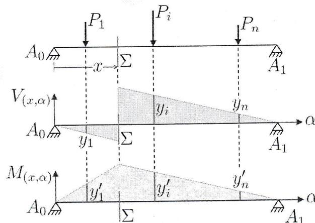
FIGURE 3.2 – Charges localisées sur la poutre
