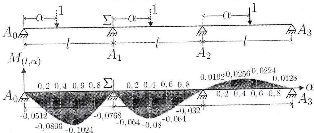
FIGURE 3.13 – Ligne d'influence du moment fléchissant à la section  $\Sigma$
