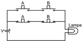
$Lampe = \overline{A \oplus B} = \overline{A\overline{B}} + \overline{A\overline{B}}$
