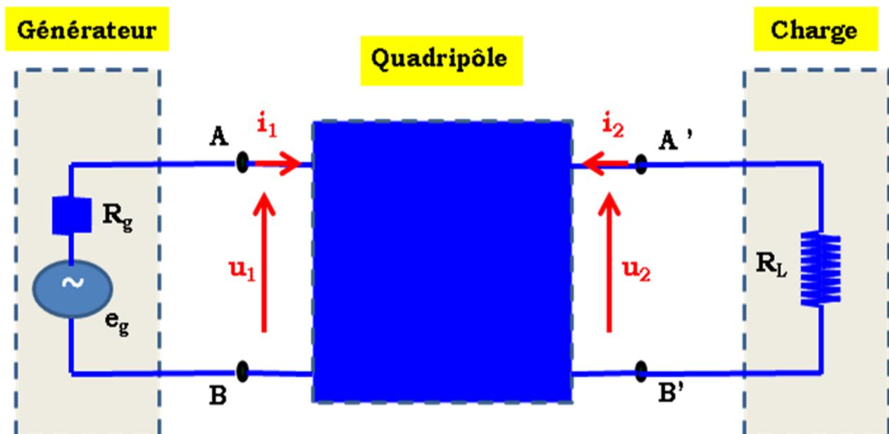
I°) On suppose que le quadripôle est défini par sa matrice de transfert ( $\underline{T}$ ) appelée également matrice chaîne inverse. On demande d'établir, en fonction de ses paramètres ainsi que les caractéristiques du générateur et de la charge, les expressions des grandeurs suivantes :
