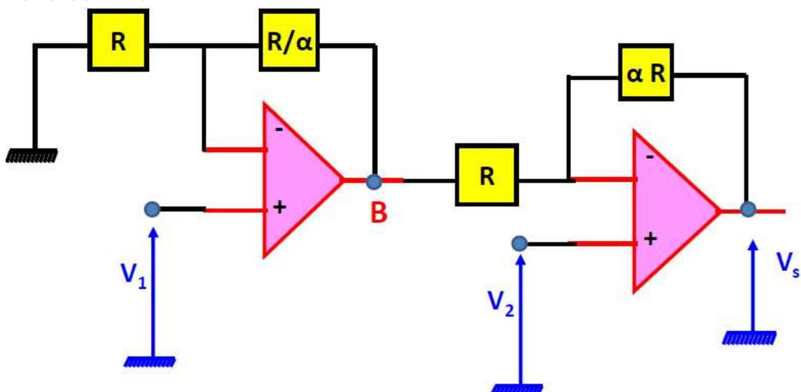
Calculons  $V_s$  en fonction de  $V_1$  et  $V_2$  :
