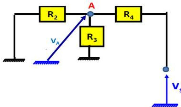
$$V_A = \frac{0}{R_2} + \frac{0}{R_3} + \frac{V_s}{R_4} = R_2 R_3 \frac{V_s}{R_2 R_3 + R_4 R_3 + R_2 R_4}$$
