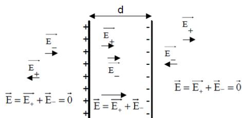
$\vec{E}_+$  et  $\vec{E}_-$  désignent respectivement les champs créés par le plan chargé positivement et le plan chargé négativement.
