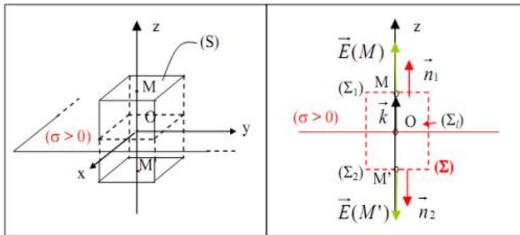
Le flux  $\vec{E}$  sortant de la surface latérale  $\Sigma_l$  du cylindre est nul, car en tout point de  $\Sigma_l$ ,
