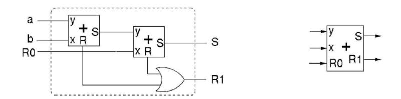
L'additionneur complet est obtenu en utilisant en parallèle plusieurs étages additionneurs (il faut autant d'étages que de bits composants les nombre binaires a additionner).
